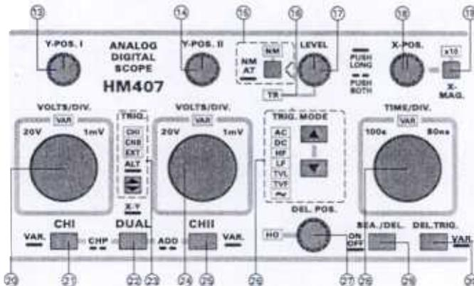
**(14) Y-POS. II** - Ce bouton permet de régler la position verticale de la trace de la voie II. Les deux boutons (**Y-POS. I** et **Y-POS. II**) sont actifs en mode **ADD** (addition).
