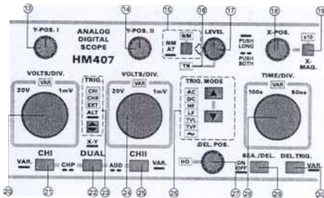
(28) **TIME/DIV.** - Le bouton qui se trouve dans la zone **TIME/DIV.** permet de régler le coefficient de déviation horizontale qui sera alors affiché en haut à gauche dans le Readout (par ex. " T:10 $\mu$ s ").
