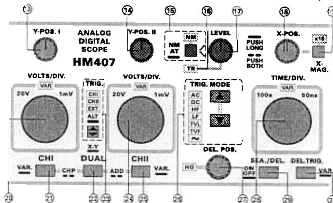
**(13) Y-POS. I** - Ce bouton permet de régler la position verticale de la trace de la voie I. Les deux boutons (Y-POS. I et Y-POS. II) sont actifs en mode ADD (addition). Le bouton Y-POS. I est désactivé en mode XY analogique dans lequel il faut utiliser le bouton X-POS. pour modifier la position X.
