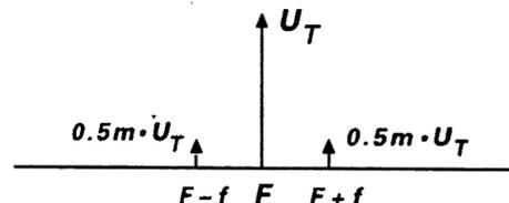
**Fig. 1 Spectre de modulation d'amplitude (m=50%).**
