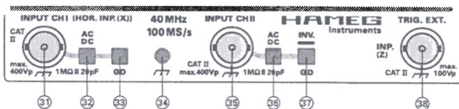
**(31) INPUT CH I (HOR. INP. (X))** - Cette prise BNC est l'entrée du signal pour la voie I. En mode XY, les signaux sur cette entrée sont employés pour la déviation horizontale. Le raccord extérieur (masse) de la prise est relié galvaniquement à la masse de l'appareil et, de ce fait, à la prise de terre du cordon secteur.
