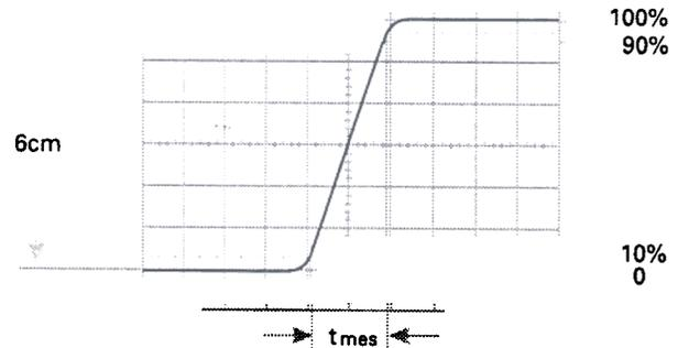
L'exemple de la figure ci-dessus donne ainsi un temps de montée du signal de
