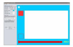
Chaque élément est configurable (couleurs), c'est également dans ces propriétés qu'on donne le nom de l'élément qui sera utilisé dans le patch pure data (ici /wavetable)
