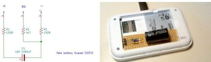
TEST EN COURS (Laisser le temps au condensateur de se charger!)
