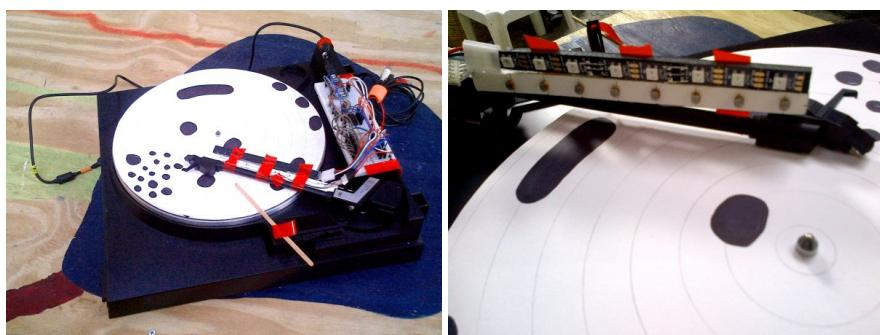
Le premier montage utilise 8 photorésistances, à chacune d'entre elle est associée une led pour fournir un éclairage homogène.
