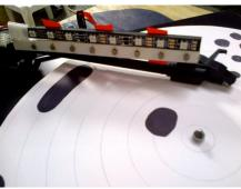
Le premier montage utilise 8 photorésistances, à chacune d'entre elle est associée une led pour fournir un éclairage homogène.
