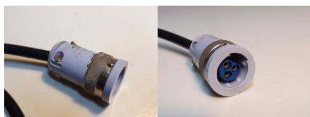
On remet temporairement un câble au connecteur chelou non-identifié de la prise secteur, pour tester l'enceinte. Il faudra plutôt choisir un câble électrique de section adaptée : 2.5 mm<sup>2</sup>
