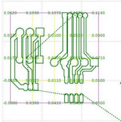
De droite à gauche les 2 premiers essayés en réglant le Z0 à la louche et dernier avec l'auto nivelage. Le résultat est parfait même avec des pistes de 0,25mm et une pointe javelot 90° 0,3mm
