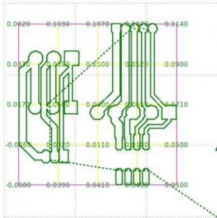
De droite à gauche les 2 premiers essayés en réglant le Z0 à la louche et dernier avec l'auto niveling. Le résultat est parfait même avec des pistes de 0,25mm et une pointe javelot 90° 0,3mm
