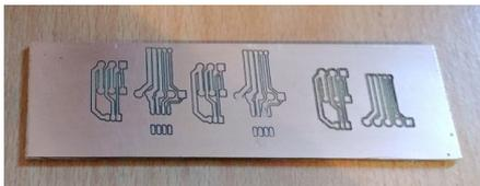
Un autre essaie avec des pistes de 0,3mm permettant de passer entre les pastilles au pas 2,54mm!
