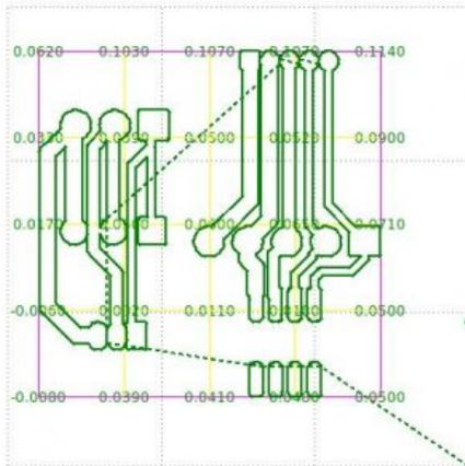
De droite à gauche les 2 premiers essais en réglant le Z0 à la louche et dernier avec l'auto nivelage. Le résultat est parfait même avec des pistes de 0,25mm et une pointe javelot 90° 0,3mm
