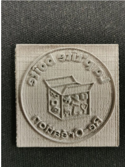
test sur chute 1 du graveur pb de matériaux, mauvais rendu final, peu creusé
