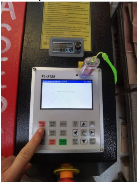
Mettre la clé USB dans la machine et appuyer sur le bouton "Reset". La machine se remet à zéro.
