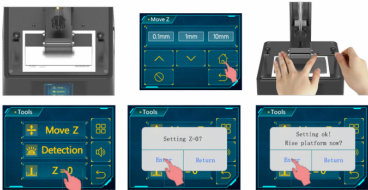
Calibration de l'imprimante Anycubic Photon Mono 4K
