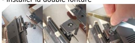
fixer la fonture avant à la fonture principale avec les vis (aux 2 extrémités)
