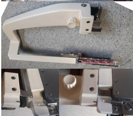
fixer le bras métallique à l'extrême gauche de la fonture principale à l'emplacement de la barre de mousse
