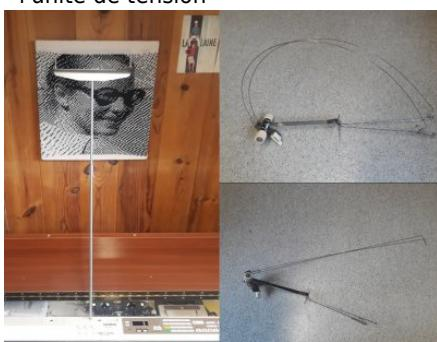
installer la tige centrale de l'unité de tension sur la machine à tricoter
