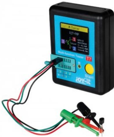
Cet appareil permet de tester les caractéristiques de plein de composants différents : résistances, condensateurs, diodes, transistors, inductances, etc. Ainsi que la charge de batteries (300 mAh / 4,5 V max) et de décoder des messages infrarouge au protocole NEC.
