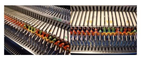
Au passage des chariots, 2 mailles se forment sur l'aiguille de la fonture principale. Problème de tension ?
