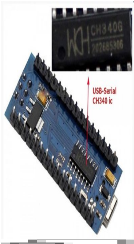
Circuit intégré CH340G de WCH. Photo Saravana Electronics , DR
