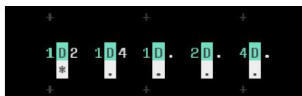
L'instruction **D** (comme Delay), déclenche un «bang» quand le modulo de la frame vaut zéro. Ce bang, symbolisé par un astérisque, permet de déclencher d'autres évènements.
