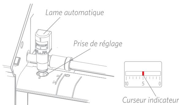
La lame automatique s'ajuste automatiquement lorsque vous envoyez votre design à la découpe. Pour régler manuellement la lame automatique ou toute autre lame, utilisez l'emplacement de réglage de la machine ou l'outil manuel fourni avec votre machine. Appuyez doucement sur la lame de haut en bas dans l'emplacement de réglage jusqu'à ce que le repère rouge indique le réglage souhaité.
