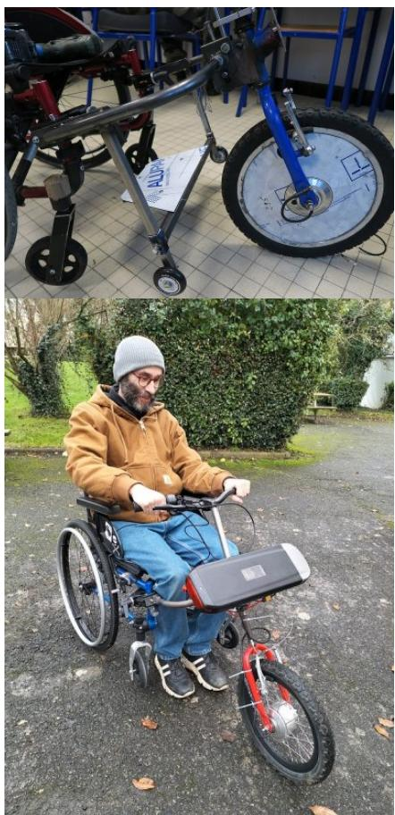
Fabrication sur-mesure d'une roue motorisée pour fauteuil roulant manuel.
