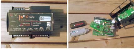
Chaque module est composé d'un «raspberry pi compute module 3» v1.0 de 2015 branchée sur une carte électronique dédiée. Sur cette carte est aussi branchée par usb, une clé lecteur de carte SIM, pour une connexion au réseau mobile, et une carte fille avec port microSD et lecteur NFC. Des borniers font l'interface avec d'autres équipements : entrée 24VDC, 2 relais 230V, port RS485.
