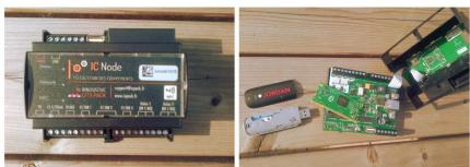
Chaque module est composé d'un «raspberry pi compute module 3» v1.0
