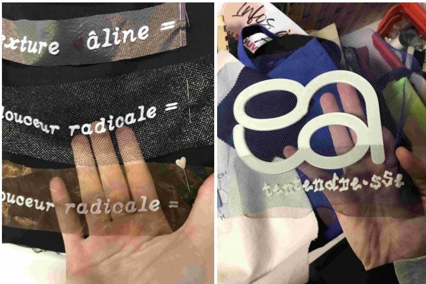
Le principe de base est qu'on laisse l'imprimante 3D faire quelques couches puis on pause la machine et on fixe le textile avec les aimants et on relance la machine pour finir l'impression. À ce moment le tulle est pris en sandwich entre les deux couches et la résine peut se rejoindre et se coller à travers les trous du tulle.
