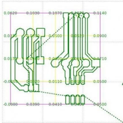
De droite à gauche les 2 premiers essais en réglant le Z0 à la louche et dernier avec l'auto nivellage. Le résultat est parfait même avec des pistes de 0,25mm et une pointe javelot 90° 0,3mm
