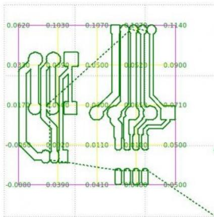
De droite à gauche les 2 premiers essais en réglant le Z0 à la louche et dernier avec l'auto niveling. Le résultat est parfait même avec des pistes de 0,25mm et une pointe javelot 90° 0,3mm
