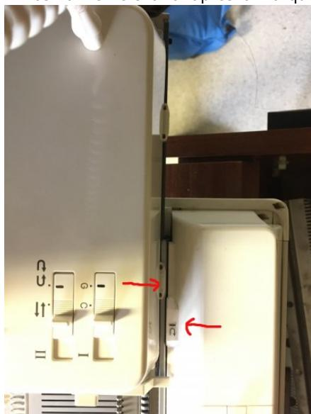
2. Allumer la machine, appuyer sur "pas à pas", appuyer sur "CE" pour vider la mémoire, entrer le numéro de motif, appuyer sur "pas à pas" 2x jusqu'à ce que la diode verte en face de "prêt" soit allumée.
